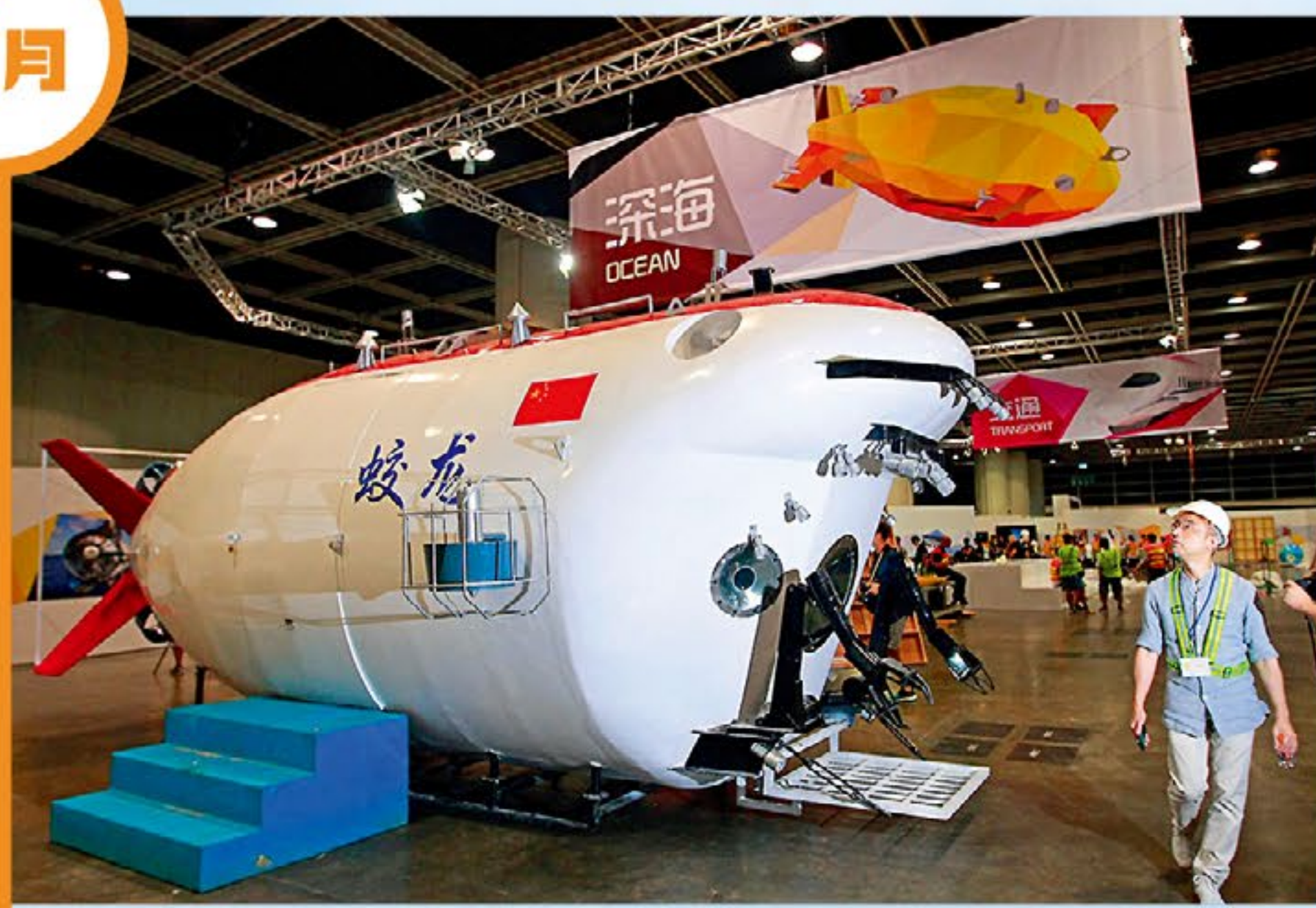
中國首台自行設計、自主集成研製的載人潛水器蛟龍號最大下潛深度達到7062米，中國海底載人科學研究和資源勘探能力達到國際領先水準
